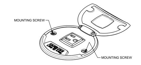
3. INSERT BUMPERS AS SHOWN OVER MOUNTING SCREWS AND MAKE ELECTRICAL CONNECTIONS AS REQUIRED.
