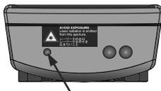
Die kleinere Öffnung (links) an der Frontseite der Fernbedienung ist die Laserstrahl-Austrittsöffnung.
